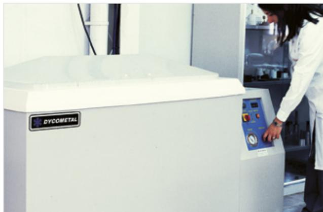
Camara de Ensayos de Corrosión.
