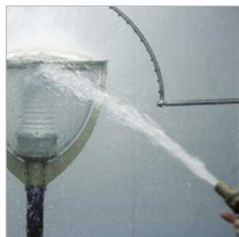
Ensayo ATP : Proyección de agua en todas las direcciones de  $100 \text{ l/min}$  con una presión de  $100 \text{ kN/m}^2$ .
