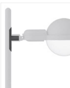
En los brazos modelos FJ-80, FX-100, FA-60 / 110, FS 45, FC-100 / 140, BL-70, MT-15-25-50-100 y MO-115 el acoplamiento a la columna va integrado en el propio brazo. NOTA: al hacer el pedido indicar el diámetro de la columna, 75, 120, 164 o 205 mm.
