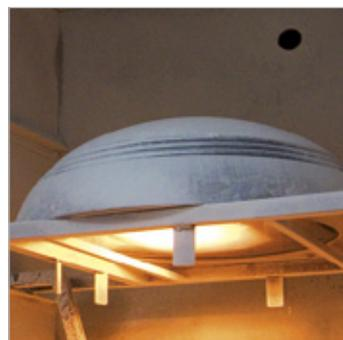
Ensayo ATP : Nube en movimiento continuo de  $2 \text{ kg/m}^3$  de polvo de diámetro inferior a  $75 \mu\text{m}$ .
